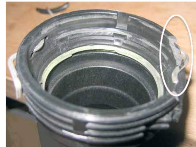
Bauteilversagen im Bereich einer Klammerhalterung
